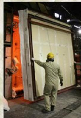
建築基準法第2条第9号基準に適合。ほとんど無機の不燃性の素材で構成された防火材です。化学建材のようにダイオキシンなどの有害ガスが発生することはありません。昔の城や蔵が漆喰で塗られていたのも、漆喰が火に強いからなのです。
